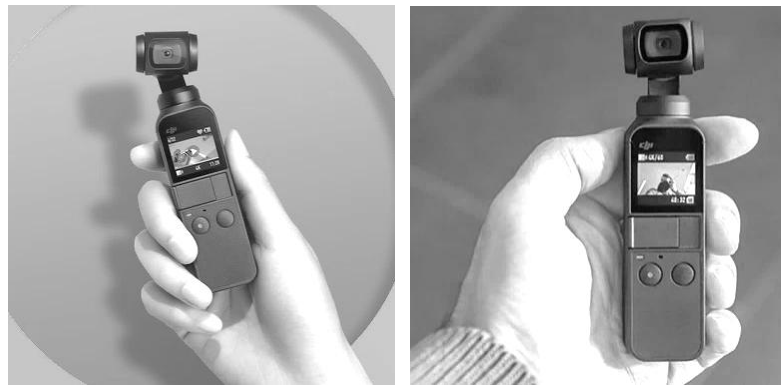
図 5-4 手のひらサイズの三軸ジンバル一体型カメラ「Osmo Pocket」
